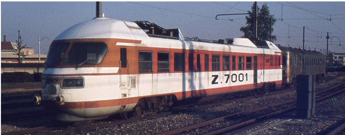
Poco antes de la avería, esto es lo que aguardaba en los garajes de Oullins : el prototipo para experimentación a alta velocidad Z-7001 "Zébulon" ( 306 km/h ) acoplado a otro no menos interesante prototipo, el automotor Budd X-2051 con caja inox. En aquel momento ( 4-1981 ), la SNCF estaba a punto de abrir al servicio la primera línea TGV Paris-Lyon y eran visibles TGV's eléctricos serie 23000 haciendo pruebas de duración por líneas convencionales.
